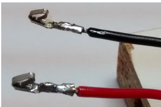
Fig. 5: Fio vermelho e preto prontos para o encaixe no Molex
