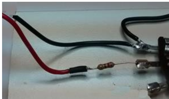
Fig 2b: fio preto e vermelho soldados no potenciômetro
