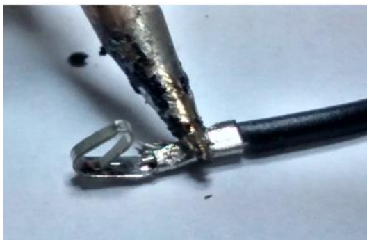
Fig. 4: Soldando o fio preto na “garra” do molex
