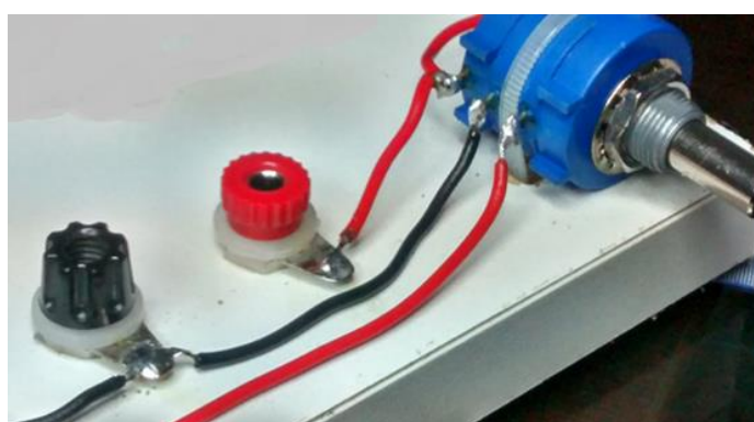
Fig. 13b: Soldas nos bornes inferiores.
