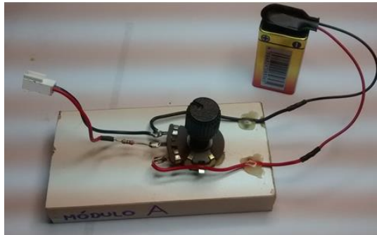
Fig. 7a: Módulo A conectado a bateria e pronto para receber o Led de Alto Brilho
