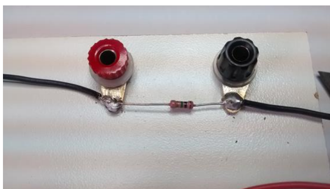
Fig. 14: solda do resistor de 1M\Omega e fios nos bornes superiores.
