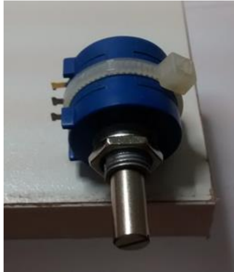
Fig. 9b: Montagem do potenciômetro multivolta.
