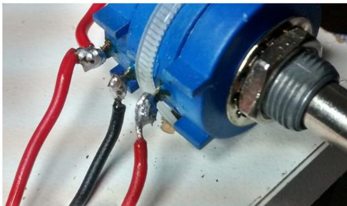
Fig. 13a: Soldas no potenciômetro
