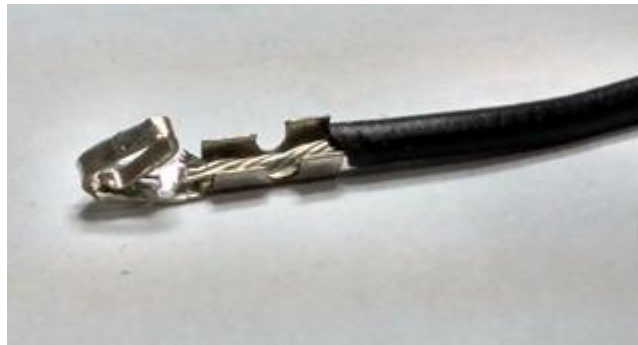
Fig. 3a: Fio preto sobre a “garra” do molex
