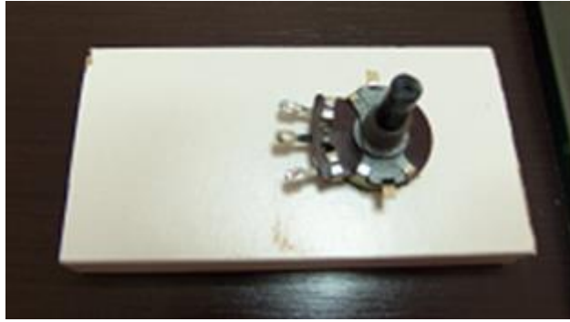
Fig.1b: Base de madeira e potenciômetro fixado.
