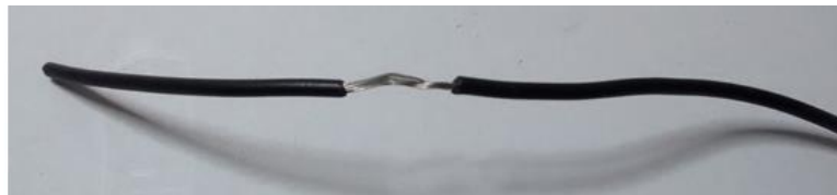
Fig 2a: fio preto descascado a ser soldado no potenciômetro
